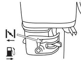
D. Mueva la palanca del acelerador a la posición alta
