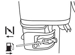
C. Mueva la palanca del aire a la posición CLOSE
