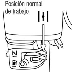
7. Regule con la palanca del acelerador el régimen de revoluciones adecuado.
