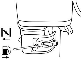
3. Coloque la palanca del aire en la posición cerrado
