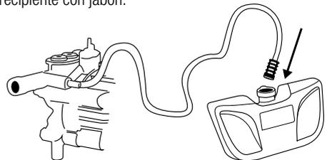
Coloque en la lanza la boquilla de baja presión.
