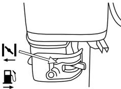
4. Coloque la palanca del acelerador en la posición máxima
