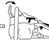
2. Colocar la cadena (3) sobre el piñón (4) mientras ajusta la cadena (3) alrededor de la barra (5) y monte la barra (5) en la máquina. Ajuste la posición del tensor de la cadena, haciendo coincidir el pivote del tornillo tensor en el agujero de la barra (6).
