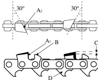
Realice el afilado de todos los dientes de una cara siempre afilando con movimientos hacia el exterior y manteniendo el ángulo de  $30^\circ$ . Cuando acabe cambie de lado y realice la misma operación.
