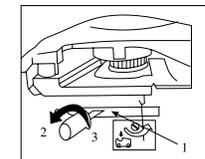
Se puede regular el flujo de aceite con el tornillo de reglaje de aceite (1) que se encuentra por debajo de la motosierra junto al embrague.
