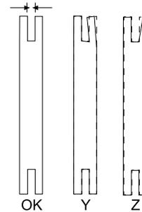
Compruebe que no existen fisuras y el nivel de holgura del rodamiento. Si nota que la holgura es importante, algún daño o fisura reemplácelo.
