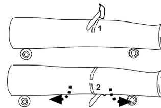
De esta manera usted evitará que la tensión interna del tronco cierre el corte bloqueando la cadena y la barra de la motosierra.
