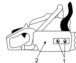
4. Regular la tensión de la cadena mediante el tornillo tensor de manera que, al tirar de la cadena en el centro de la barra, ésta se pueda levantar pero sin llegar a salirse de la guía de la barra y vuelva a su posición dentro de la guía una vez que usted la suelta.
