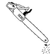
Después de arrancar el motor, acelere la motosierra hasta que la cadena gire a una velocidad media y verifique si la motosierra engrasa la cadena, para ello valdrá con observar que al colocar la motosierra como en la figura a medio régimen sale despedido aceite.
