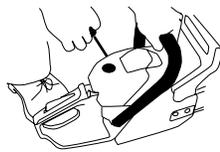
6. Tire de la cuerda de arranque hasta que el motor haga una explosión o arranque.
