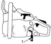
Compruebe el filtro de combustible periódicamente. No permita que entre suciedad en el depósito de combustible para evitar que el filtro se ensucie. Un filtro sucio hará más difícil el arranque del motor y producirá anomalías en el funcionamiento o parada del mismo.
