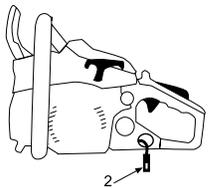
Compruebe el filtro de aceite periódicamente. No permita que entre suciedad en el depósito de aceite para evitar que el filtro se ensucie. Un filtro sucio puede no permitir el paso de aceite de engrase y producirá el desgaste excesivo de la cadena y barra de la motosierra.
