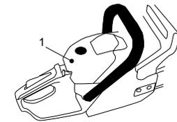
Para limpiar el filtro retire la tapa protectora (1) y saque el filtro.
