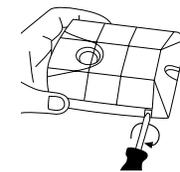
Para limpiar la suciedad que se encuentre en el interior del filtro, separe las dos partes del filtro utilizando un destornillador como se indica en la figura.
