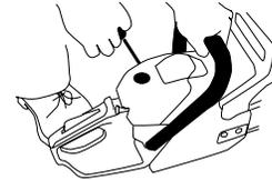
6. Tire de la cuerda de arranque hasta que el motor haga una explosión o arranque.
