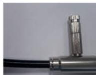
5. Al principio de la tubería coloque el conector a la máquina en la toma de OUT.
